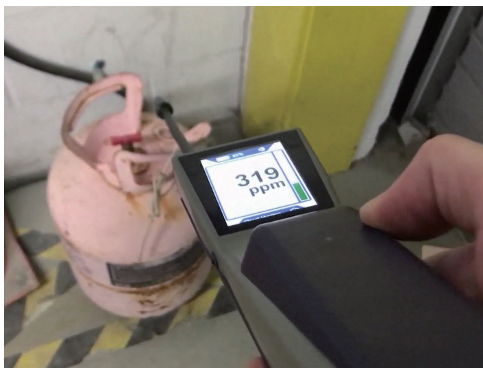
Cloud-Hunting 模式：在充满冷媒的空间内，离泄露位置越近，读数越高，便于找到漏点。
